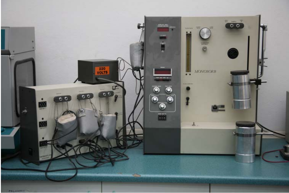
Yüzey Kimyası laboratuvarı-BET Yüzey Alanı Ölçüm Cihazı
