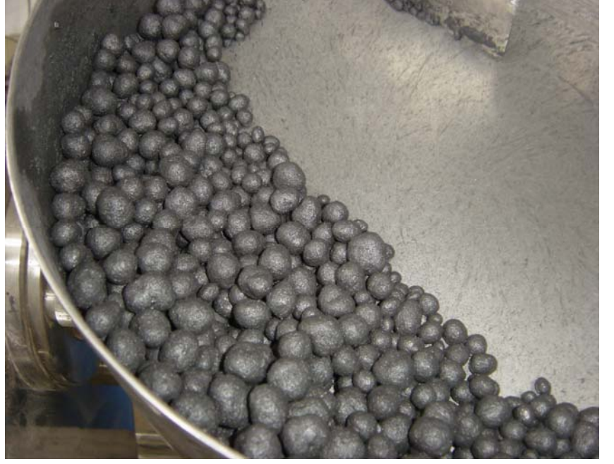
Kömür Teknolojisi laboratuvarı-Peletleme Diski
